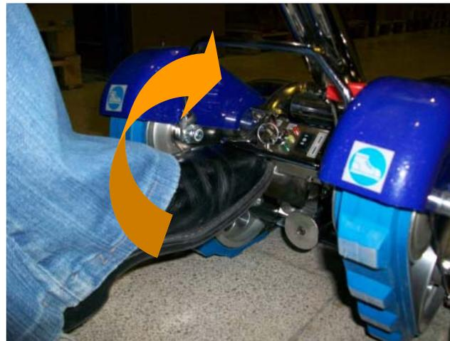
2.- Levantar con el pié hacia arriba la palanca de enganche del manillar a la base.
