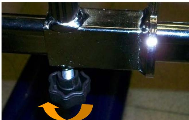
8.- Apretar de nuevo los pomos de ajuste en anchura girándolos hacia la izquierda para fijar la posición de los enganches
