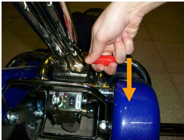
1.- Con la oruga apagada (llave en OFF) liberar la palanca roja de bloqueo del manillar tirando de ella hacia atrás
