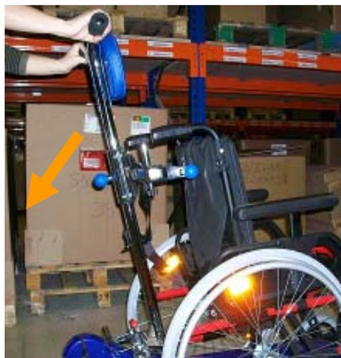
9.- Con el usuario ya sentado en la silla, bloquee de nuevo el manillar en la base tirando de él hacia abajo. Un click confirmará que el manillar se ha bloqueado correctamente
