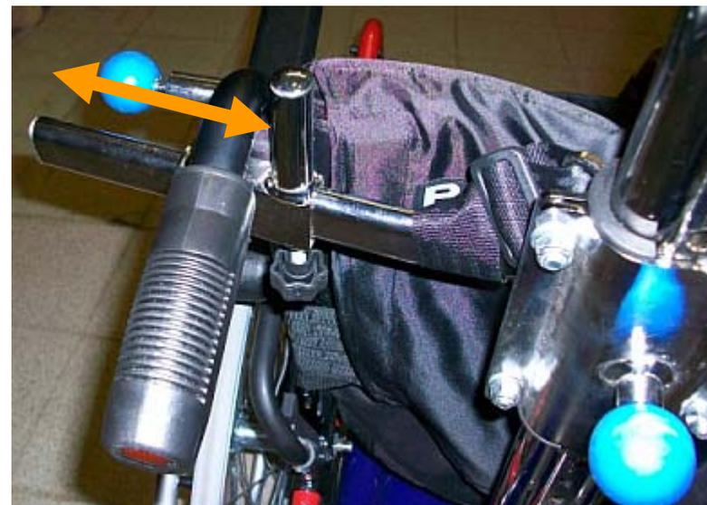
6.- Deslice los enganches hasta que entren en contacto con el respaldo de la silla
