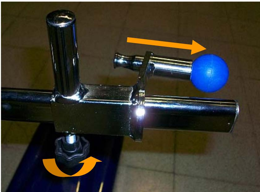
4.- Gire hacia la derecha para aflojar los pomos de ajuste en anchura de los enganches
