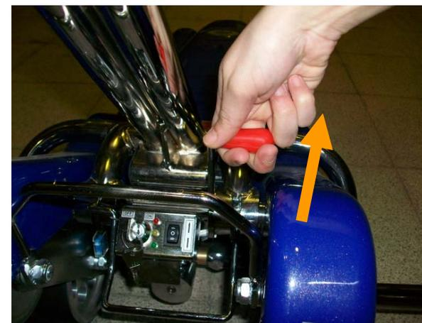
10. – Tire hacia arriba la palanca roja para asegurar y bloquear de nuevo la posición del manillar
