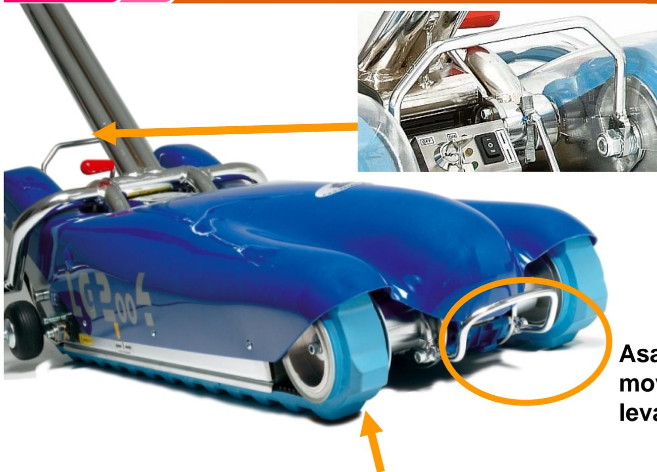
**Asa trasera para ayudar a mover manualmente o levantar la base de la oruga**
